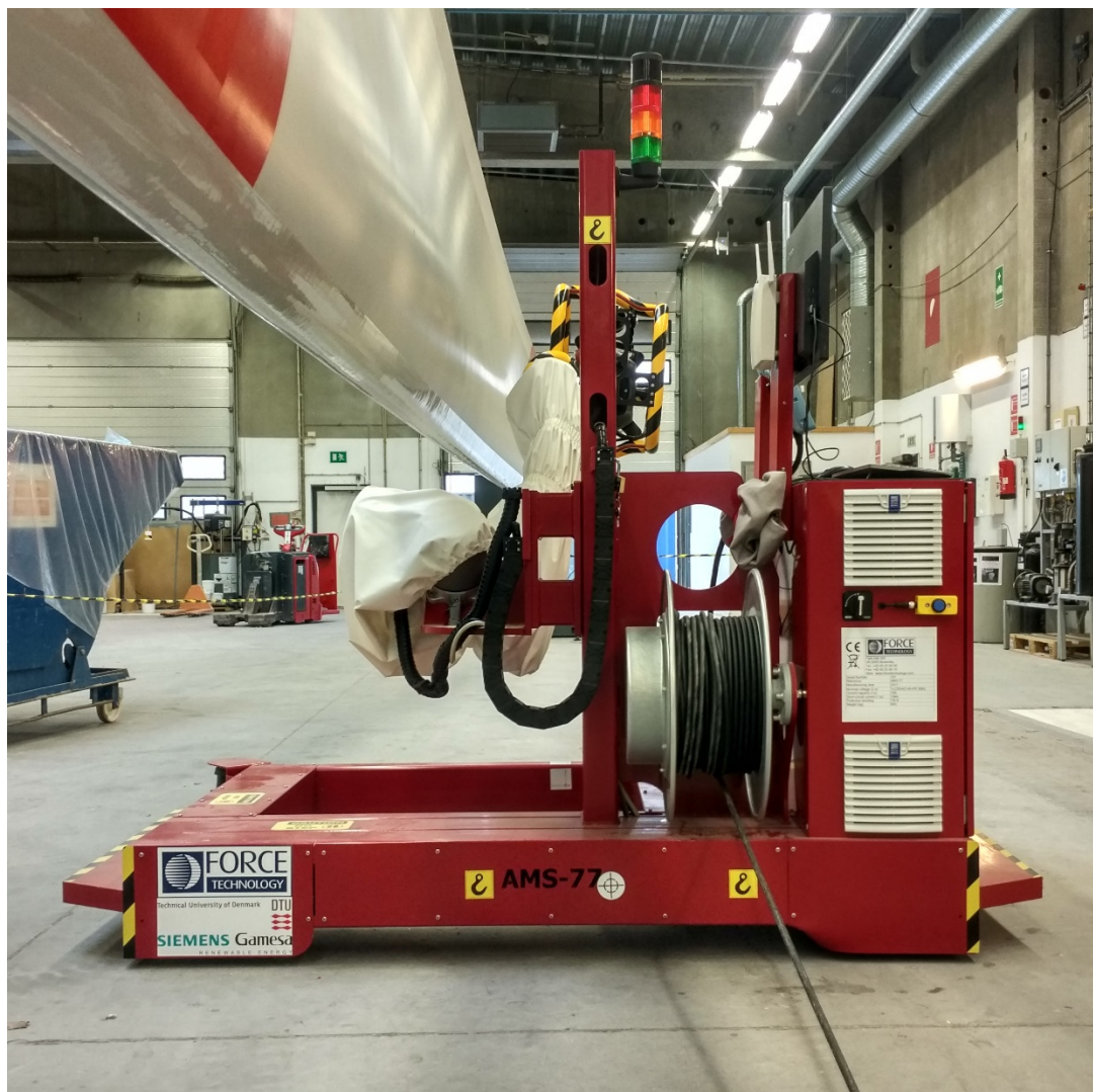
Robotscanner til vindmøllevinger Foto: Siemens Gamesa
