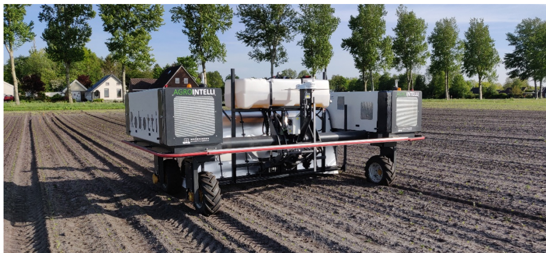
Spot sprøjtning med den autonome landbrugsrobot Robotti fra AGROINTELLI
